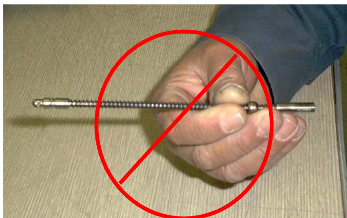
SLIKA 8. Vrlo opasan izvor iz radiografske kamere (ne smije se nikad primiti u ruku).
